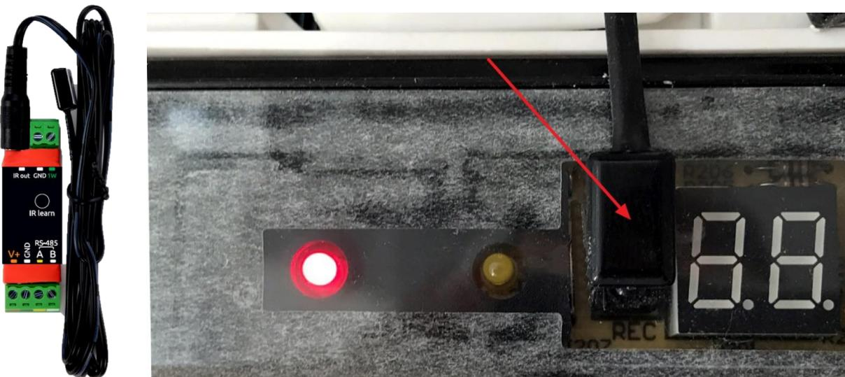
Пример монтажа ИК-излучателя модуля SH-IRGateMU на приемнике кондиционера под декоративной крышкой
